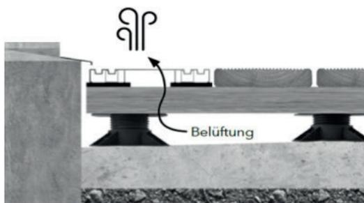
Für eine optimale Belüftung der gesamten Konstruktion ist bei angrenzenden Objekten ein Ventilationsprofil RELO V einzusetzen.
