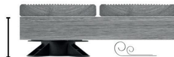
Zur optimalen Durchlüftung ausreichend Abstand zum Untergrund  $\geq$  **150 mm** vorsehen.
