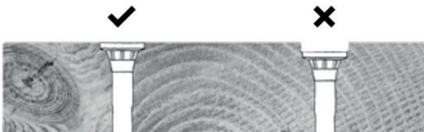
Die Terrassenschrauben müssen bündig mit der Oberfläche verschraubt werden. Dadurch werden Stolperstellen durch heraus stehende Schrauben bzw. Staunässe (Fäulnis) durch zu tief versenkte Schrauben vermieden.
