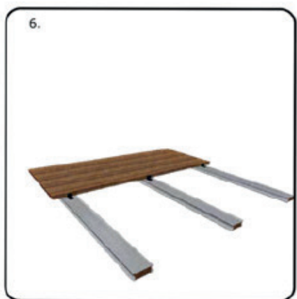
6. Diele (inkl. SenoFix Verbinder) an Unterbauwaagen legen. Der Verbinder gibt den Fugenabstand von 7 mm vor.
